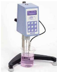
Soporte y husillos estándar L1, L2, L3 y L4 para modelos L.
